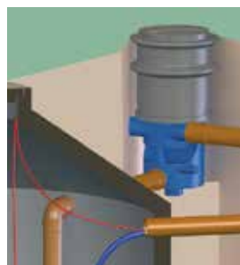
Volumenfilter VF 1 (geeignet für Auffangflächen bis 350 m 2 ) beim Typ SVF und KVF, Höhendifferenz zwischen Zu- und Ablauf 30 cm. Dies ist beim Aushub der Grube und der Verrohrung unbedingt zu berücksichtigen!
